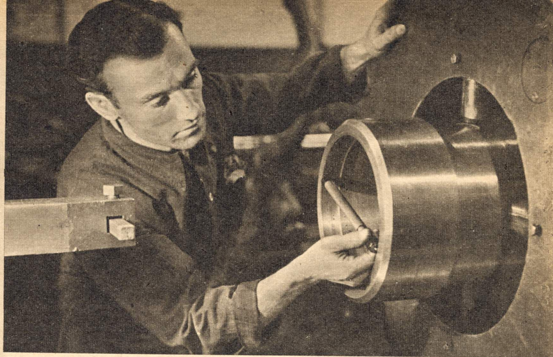
Rechts: Ein Arbeiter kontrolliert an der Bohrbank den Durchmesser des Mantelrohres eines 8,8-cm-Flakgeschützes
